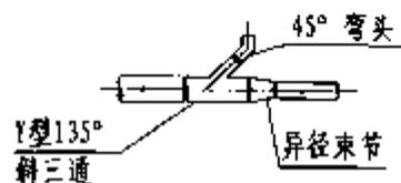
支管接入主悬吊管大样图
