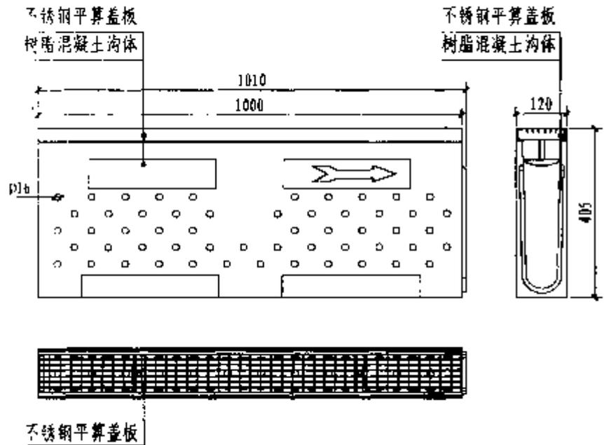
渗透式树脂混凝土排水沟示意图
