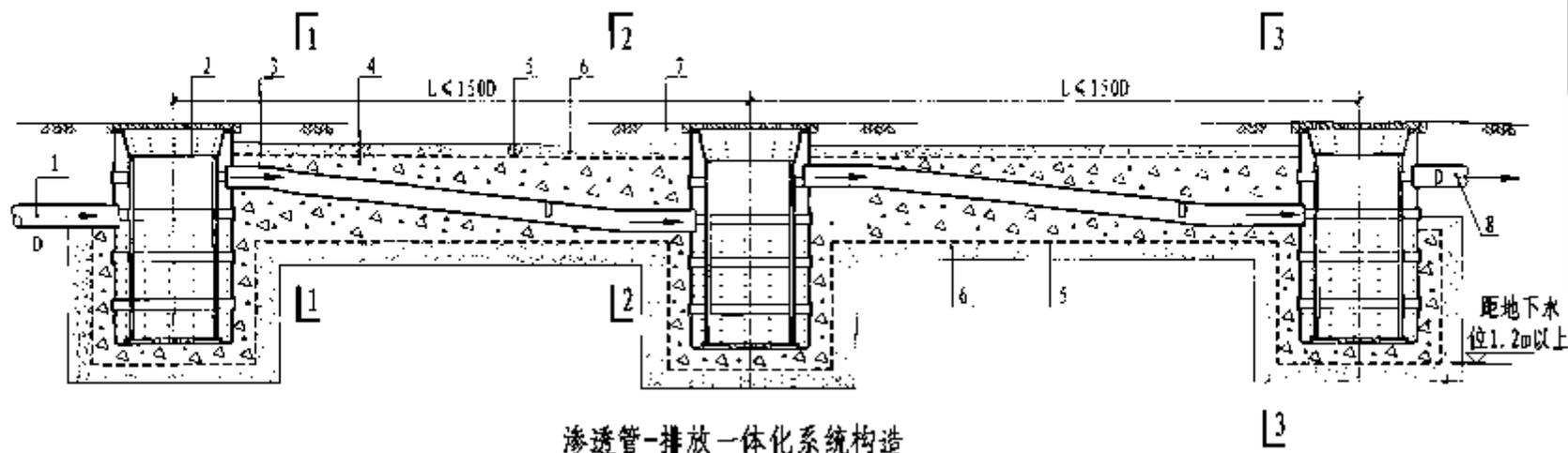
渗透管-排放一体化系统构造
