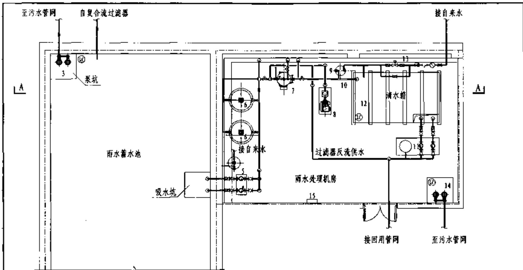
雨水（混合反应过滤）处理平面图
