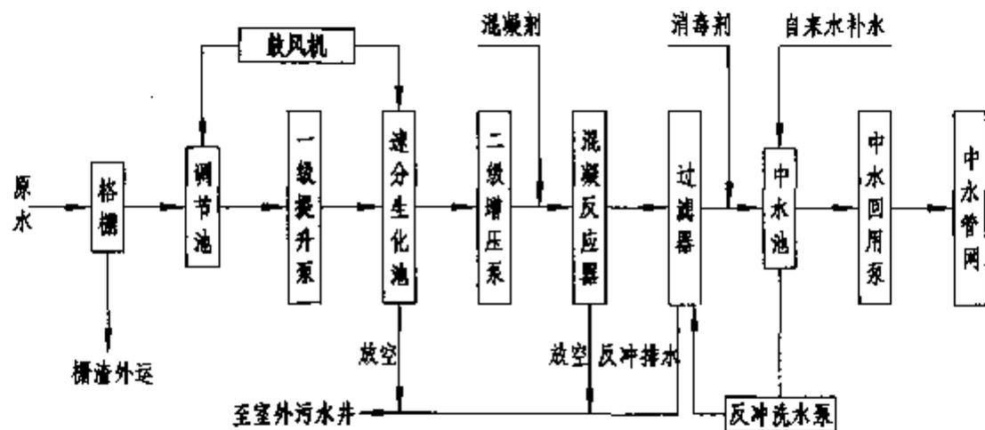
速分生物处理工艺流程框图
