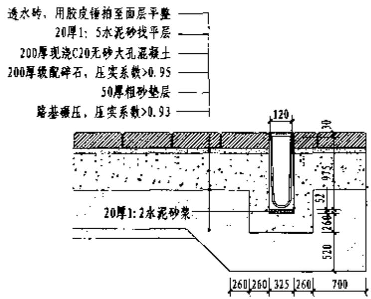
渗透式树脂混凝土排水沟安装图
