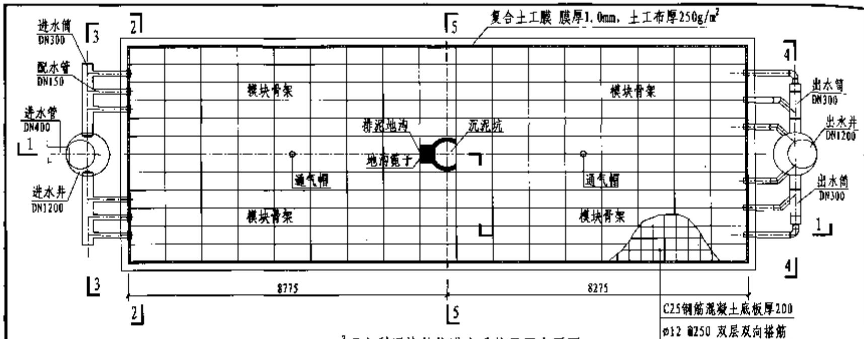
240m<sup>3</sup>雨水利用构筑物进水系统平面布置图
