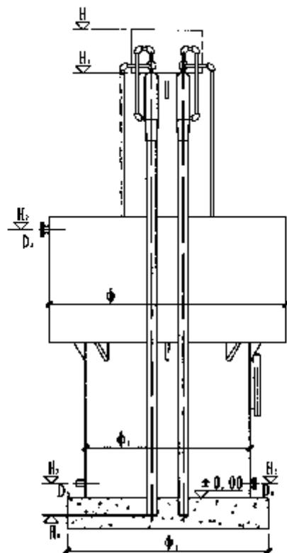
说明: 1. 高效无阀过滤器的功能是去除水中较小的悬浮杂质, 它是无阀过滤器改进型产品, 水力自动运行, 不需操作。
