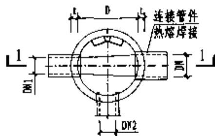
图1 直壁式检查井平面图
