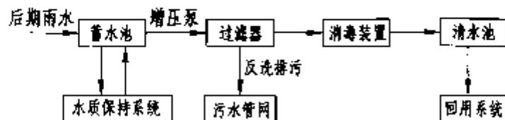
收集水质较好的屋面雨水,经弃流掉初期水质较差的雨水后,进入蓄水池调蓄储存,一般认为雨水储存5天以上,水质即会发生恶化,产生气味、颜色变黑等问题,宜设置雨水水质保持设备。雨水利用增压泵增压至过滤器进行过滤,截留原水中含有的悬浮物、吸附部分胶体状态的污染物,之后进入清水池进行消毒以备回用。
