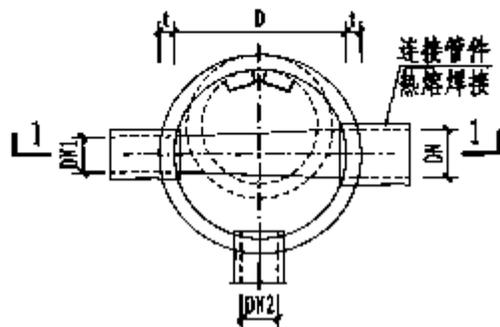
图4 台阶式检查井平面图
