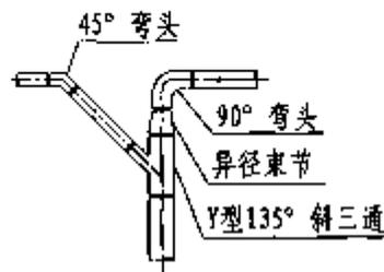
两条悬吊管接入同一立管大样图
