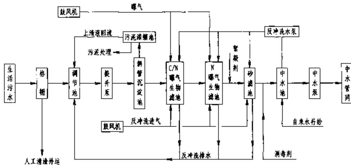
曝气生物滤池工艺流程框图
