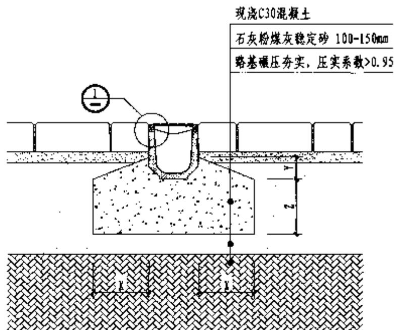
树脂混凝土排水沟安装图
