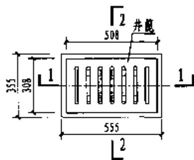
透透式雨水口安装平面图
