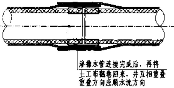
管材连接大样（通过尼龙扎带连接）
