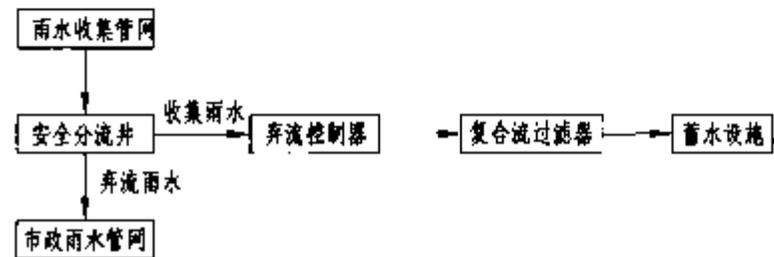
适用范围:以上初期雨水弃流控制系统适用于单独收集屋面雨水以及收集屋面、地面、道路地坪雨水的入渗、调蓄排放和处理回用的各种雨水利用系统。
