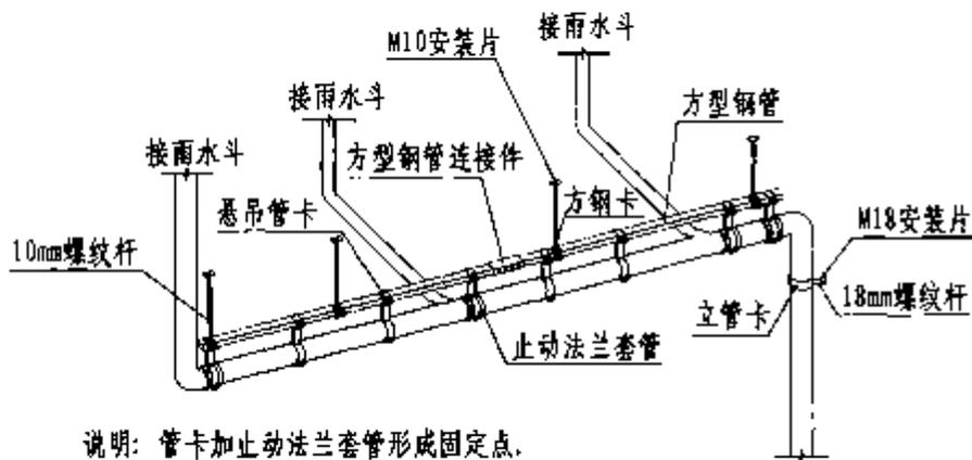
说明：管卡加止动法兰套管形成固定点。
