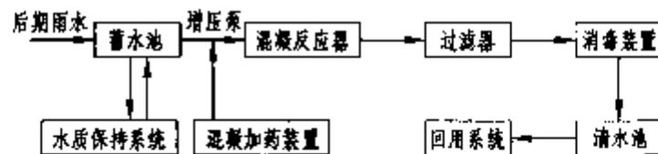
利用将雨水增压泵增压至混凝反应器与混凝药剂(宜采用聚合氯化铝)进行混凝反应,吸附去除雨水中含有的悬浮物、吸附胶体状态的污染物以及磷酸盐后,再进行过滤消毒后入清水池以备回用。
