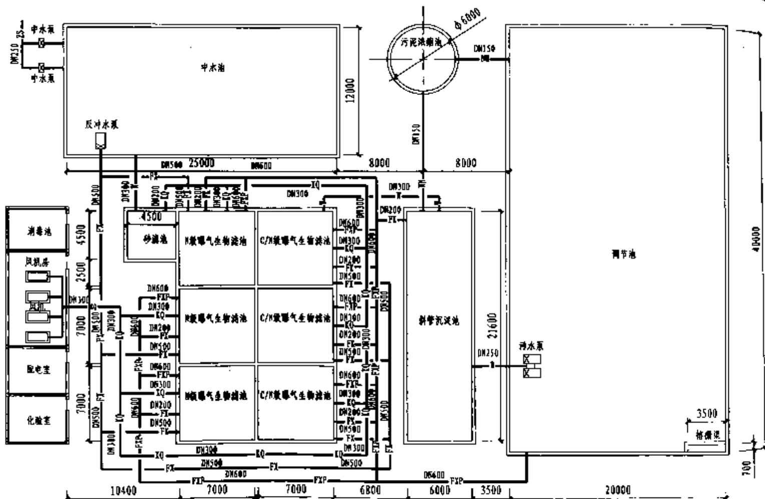
曝气生物滤池工艺管线平面图 (200m<sup>3</sup>/h)
