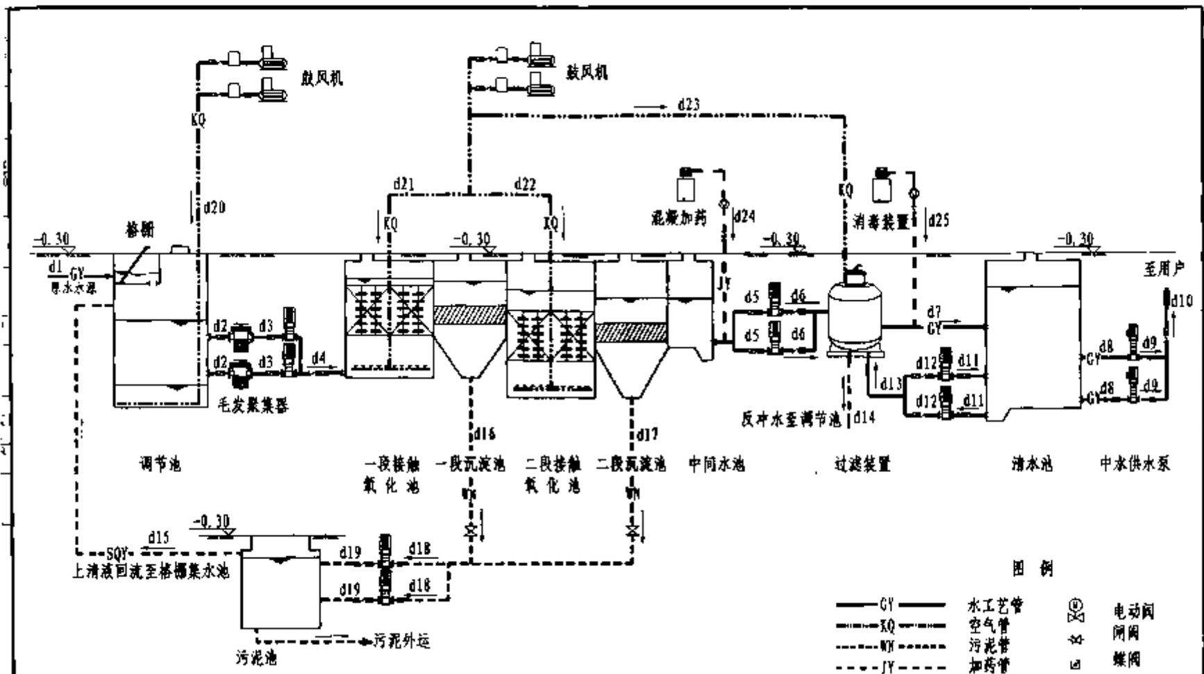
接触氧化法工艺流程图
